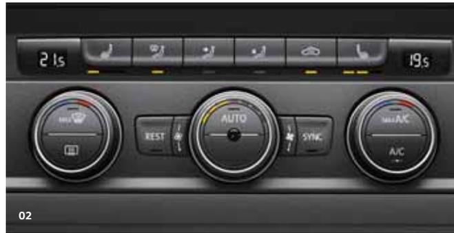
**02 Optionale Klimaanlage „Climatronic“.** Dieses System bietet eine 2-/3-Zonen-Temperaturregelung für Fahrer, Beifahrer und Wohnraum. Die automatische Umluftschtung, der Luftgütesensor und die optionale Zusatzheizung schaffen ein angenehmes Klima.
