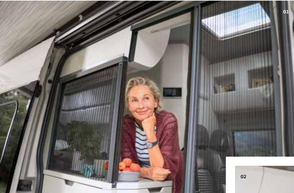
**01 Zweiteiliges Moskitonetz an der Schiebetür.** Die gesamte Öffnung der Schiebetür wird passgenau abgedeckt. Beide Netzte sind in leichtgängigen Profilen verschiebbar. Abbildung zeigt Grand California 680.
